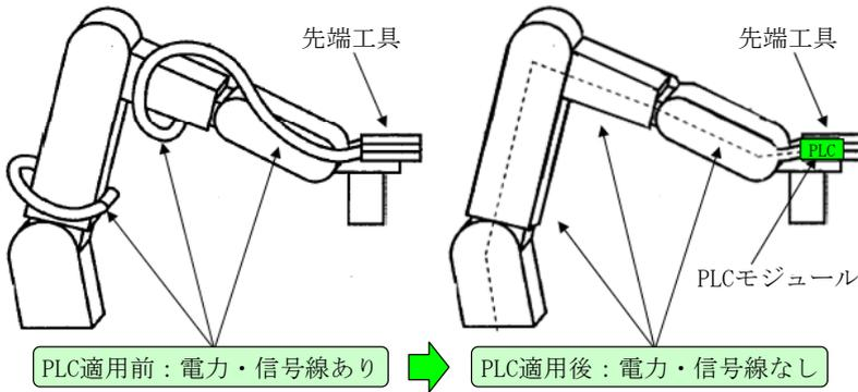
図1：PLC適用による省配線化
